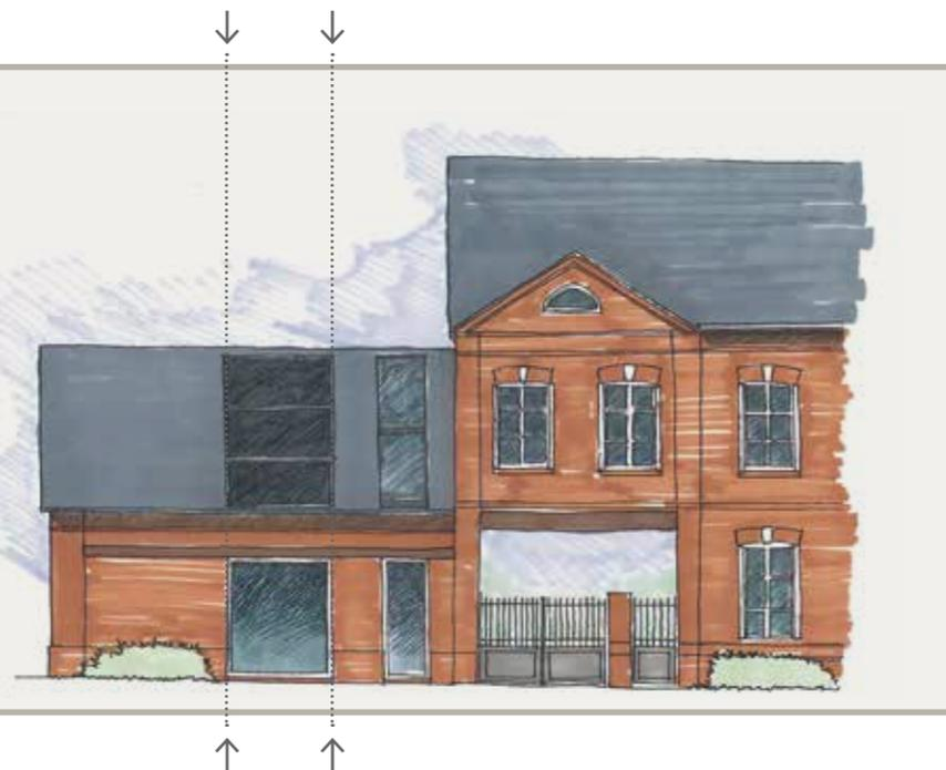
La pose de panneaux sur l'annexe accolée au bâti principal est cohérente avec les dimensions et le rythme des ouvertures en façade.
