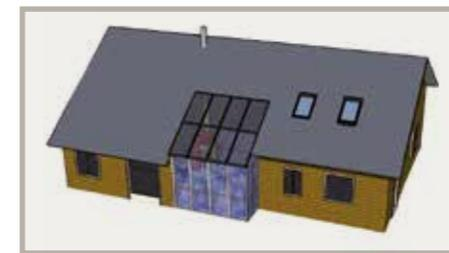
La pose de panneaux sur un volume en décroché s'avère également efficace. Profiter d'une extension pour intégrer ces panneaux avec la création d'un auvent pour la terrasse ou d'une véranda avec un jeu de transparence. → .....
