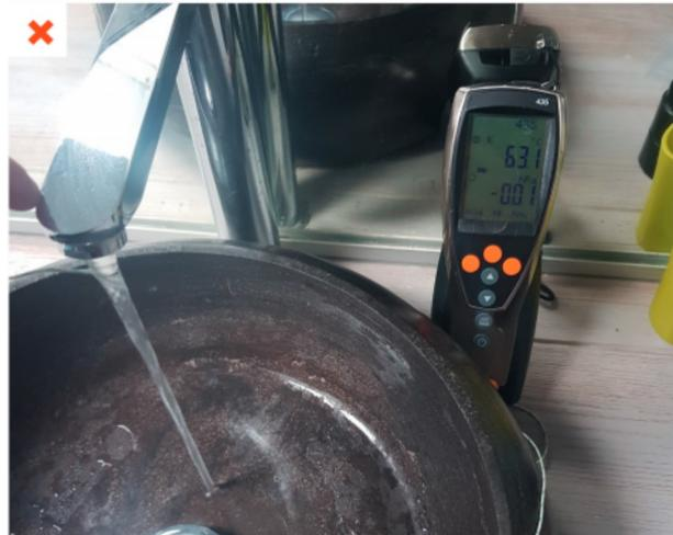
Une mesure au point de puisage montre une température de l'ECS à 63 °C dans la salle de bain. @AQC
