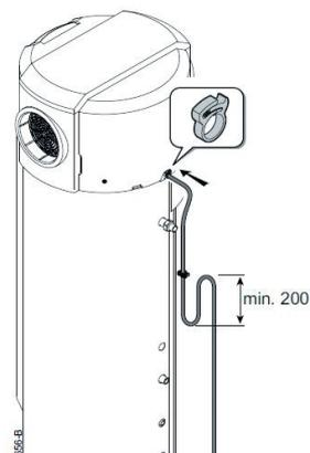
La nécessité d'un siphon est précisée sur la notice du fabricant. ©AQC
