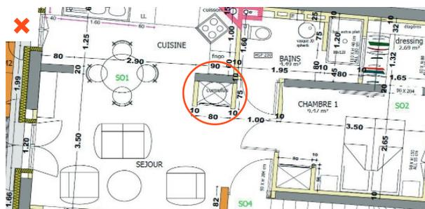
Le CET monobloc est situé au centre du logement, à proximité des pièces de vie et dans un placard dont la porte n'est pas isolée acoustiquement. ©AQC
