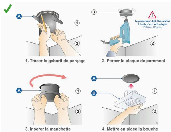
Les notices d'installation des fabricants permettent une bonne mise en œuvre de la manchette de raccordement. @ Cerema - Romuald Jobert
